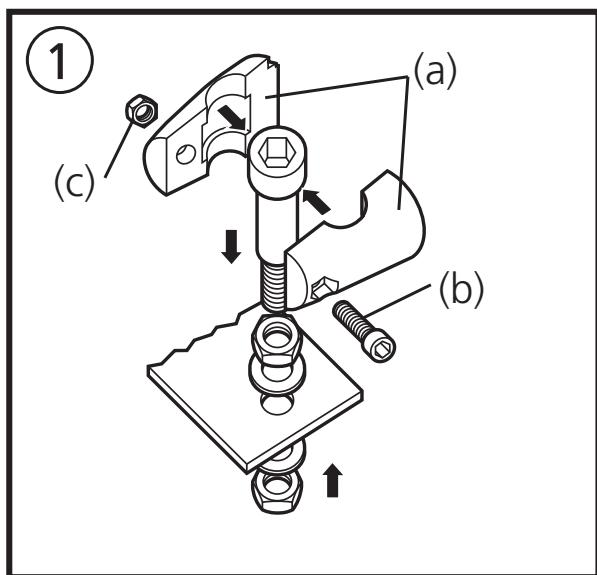
Montieren Sie die beiden Schellenhälften (a) lose mit Hilfe der beiliegenden Schraube (b) und Mutter (c).
