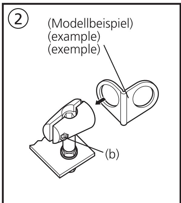
Befestigen Sie einen Haltewinkel (nicht im Lieferumfang) und ziehen Sie nach erfolgter Justage die Schraube (b) fest.
