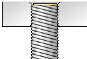
Все датчики с монтажом "заподлицо" *iprox*®+ резьбового цилиндрического типа также предусматривают возможность утопленного монтажа. Безопасная эксплуатация обеспечивается, если датчик ввинчивается на 0,5 мм.
