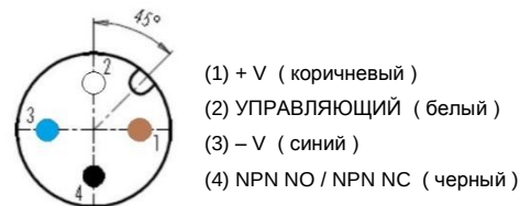
Датчик с разъемом M12, 4-pin, штекер "папа", NPN NO / NC выход
