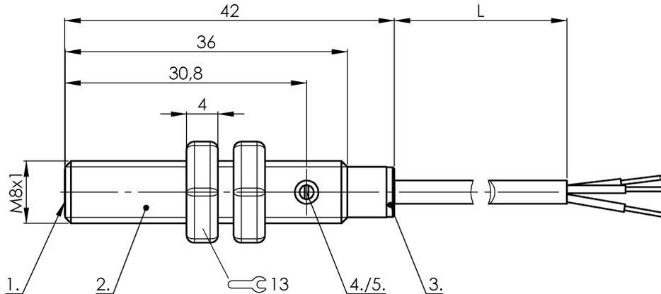
1) Активная поверхность, 2) Корпус, 3) Крышка, 4) Потенциометр, 5) Функциональный СД
