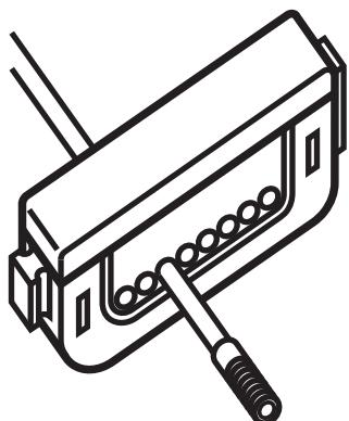
Schneiden Sie die Fiberoptik auf die passende Länge. Benutzen Sie jedes Loch des Cutters nur einmal!
