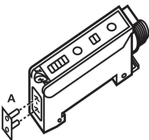
Adaptieren der Lichtleiter: s. Bedienungsanleitung zu Schaltverstärker OBF. Ist der Außendurchmesser der Lichtleiter < 2,3mm, muß zuerst der beiliegende Adapter (A) in den Schaltverstärker eingesetzt werden.
