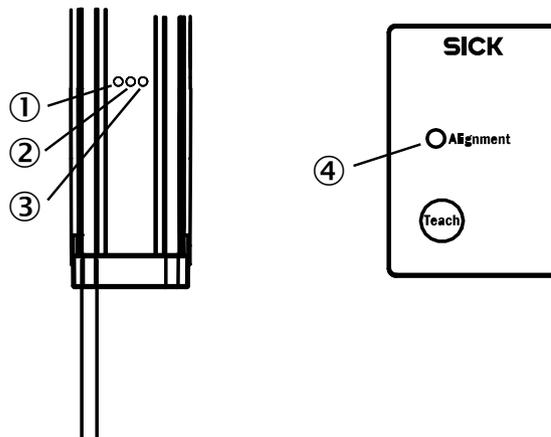
Figure 18: LEDs auf der Vorderseite und am Bedienfeld
