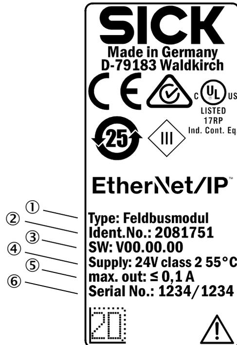
Figure 3: Fieldbus module type label
