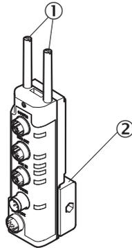
Figure 41: Feldbusmodul mit QuickFix-Halterung abgesetzt montieren
