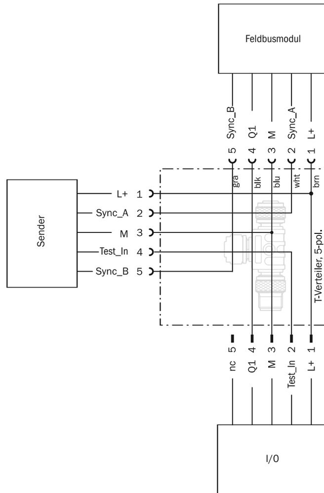
Figure 45: T-Verteiler Sender und Feldbusmodul
