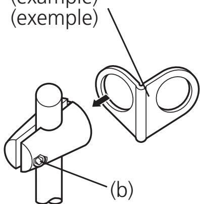
Befestigen Sie einen Haltewinkel (nicht im Lieferumfang) und ziehen Sie nach erfolgter Justage die Schraube (b) fest.
