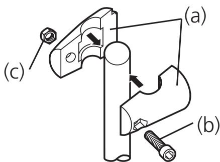
Montieren Sie die beiden Schellenhälften (a) lose mit Hilfe der beiliegenden Schraube (b) und Mutter (c).
