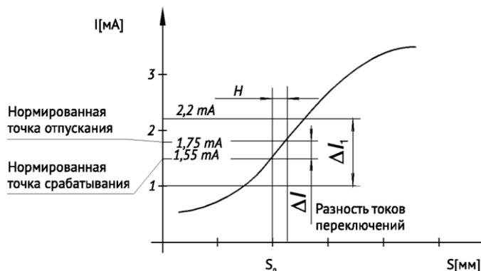
Рис.2 - Зависимость тока датчика от расстояния срабатывания
