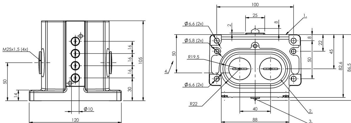
1) Опорная кромка, 2) Уплотнительное кольцо, 3) Функциональный индикатор FD/FE/LL, 4) Кабельный ввод
