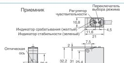
Два, М3 Кабель круглого сечения, диаметр 4, с виниловой изоляцией, с 3-мя жилами (поперечное сечение жилы: 0,2 мм²; диаметр изоляции 1,1 мм); стандартная длина: 2 м
