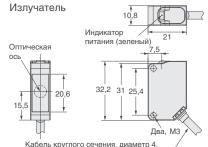
Кабель круглого сечения, диаметр 4, с виниловой изоляцией, с 2-мя или 3-мя жилами (поперечное сечение жилы: 0,2 мм²; диаметр изоляции 1,1 мм); стандартная длина: 2 м
