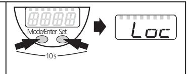
Во время эксплуатации: [Loc] кратко отображается при попытке внесения изменений в значения параметров.
