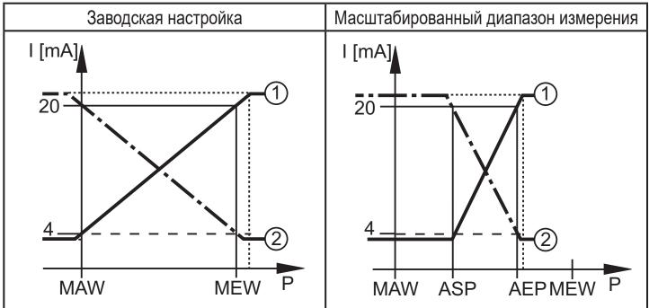
P = давление в системе, MAW = начальное значение диапазона измерения, MEW = конечное значение диапазона измерения
