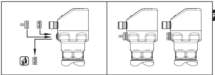
Когда используется закрытая крышка, измерение может отклоняться из-за колебаний атмосферного давления и колебаний давления внутри прибора (так как нет компенсации измерительной ячейки на окружающую среду) (Δ 10 K ≤ 30 мбар).
