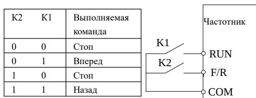
Рис. 6-14 Двухпроводной режим управления 2
