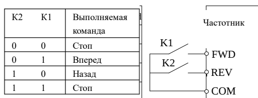
Рис.6-13 Двухпроводной режим управления 1
