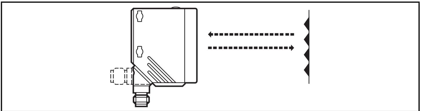
► Установите призматический отражатель или отражающую пленку за контролируемым объектом.
