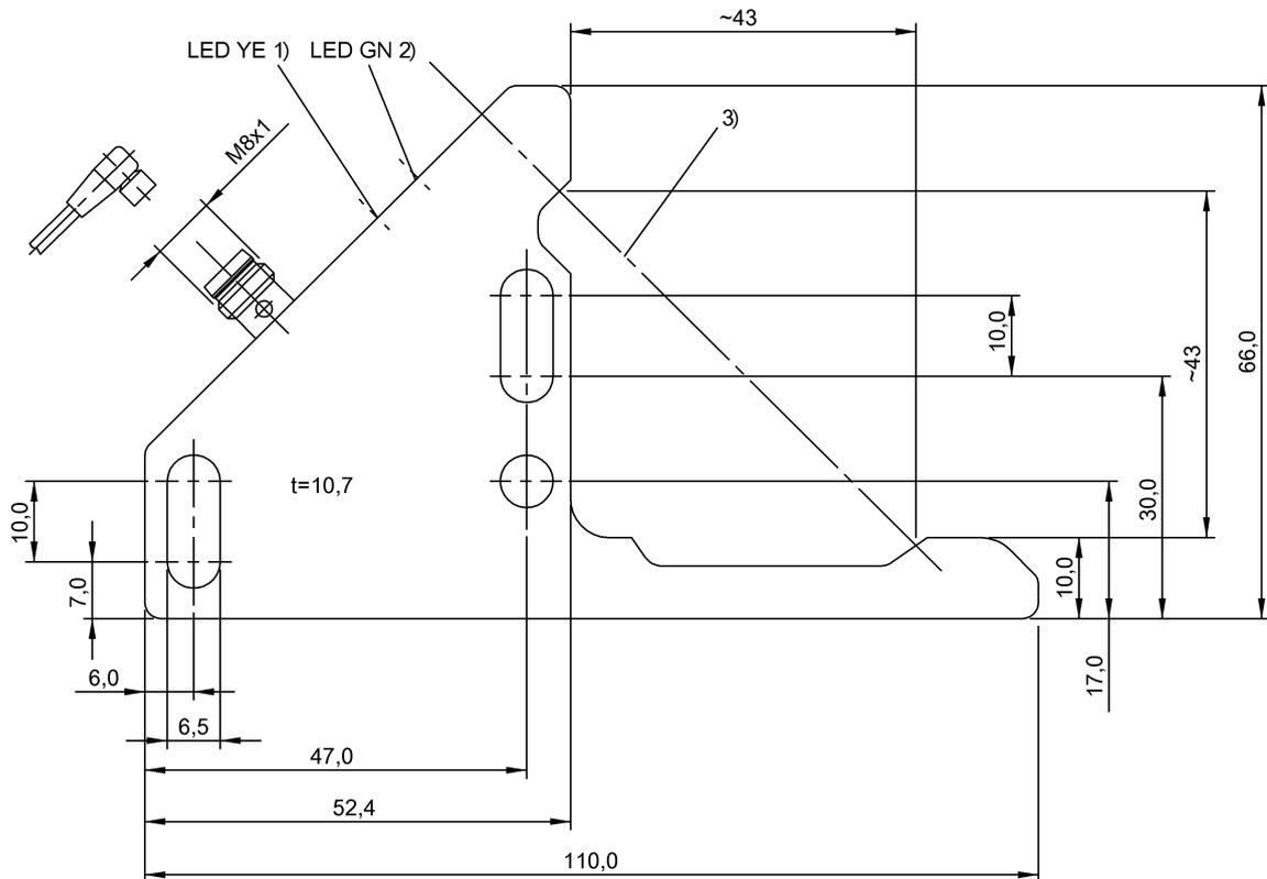
1) Функция выхода, 2) Напряжение питания, 3) Оптическая ось
