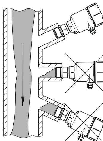
При установке в стенку емкости, кабельный ввод должен быть направлен вниз. Для герметичности используйте кабель соответствующего сечения.
