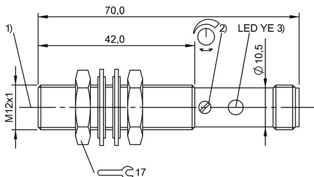
1) Оптическая ось, 2) Sn, 3) Функция выхода
