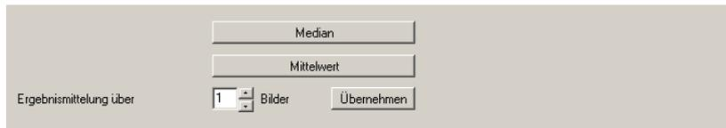
Bei den räumlichen Filtern Median und Mittelwert wird die "3x3 Mittelung" genutzt. Zunächst wird der Messwert eines zu filternden Pixels betrachtet. Dieser wird dann in Relation zu den 8 angrenzenden Pixeln gebracht. Jeder Filter errechnet einen Mittelwert aus den 9 Pixeln, die Berechnungsvorgaben für die verschiedenen Filter variieren dabei.
