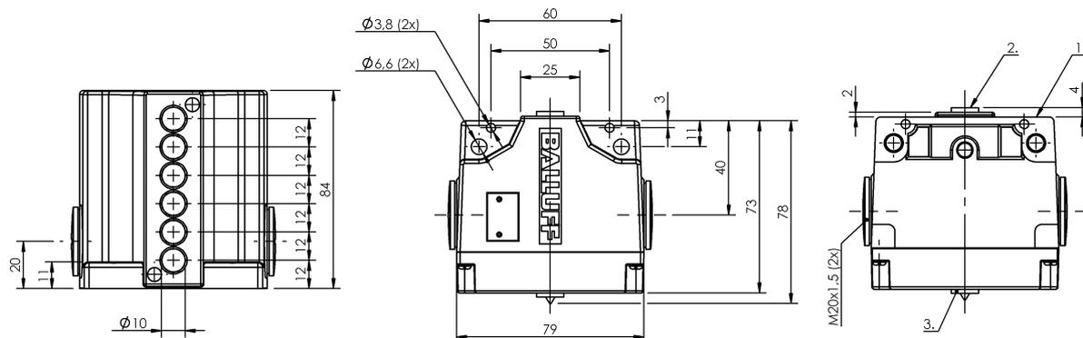
1) Опорная кромка, 2) Активная поверхность, 3) Функциональный индикатор FD/FE/LL
