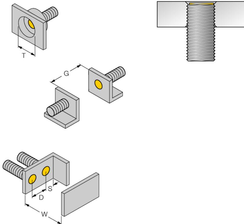
Все датчики с монтажом "заподлицо" *iprox*®+ резьбового цилиндрического типа также предусматривают возможность утапливаемого монтажа. Работоспособность гарантируется при вкручивании датчика на глубину половины витка резьбы.
