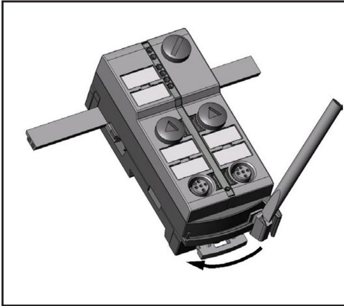
Abra el equipo como se indica en la imagen con una herramienta (p. ej. un destornillador).
