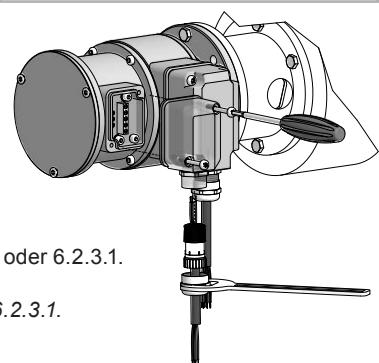
Zur Gewährleistung der angegebenen Schutzart sind nur geeignete Kabel-durchmesser zu verwenden.
