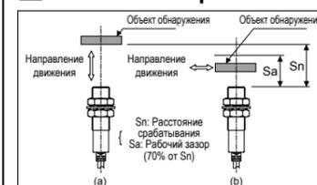
• Расстояние срабатывания может изменяться в зависимости от формы, размера и материала объекта. Проверьте расстояние срабатывания (а), затем переместите объект в пределах рабочего зазора Sa (b).
