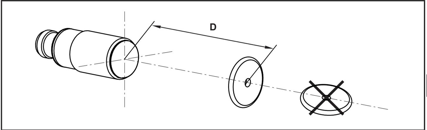
► ID-TAG zentrisch zur Antenne ausrichten
