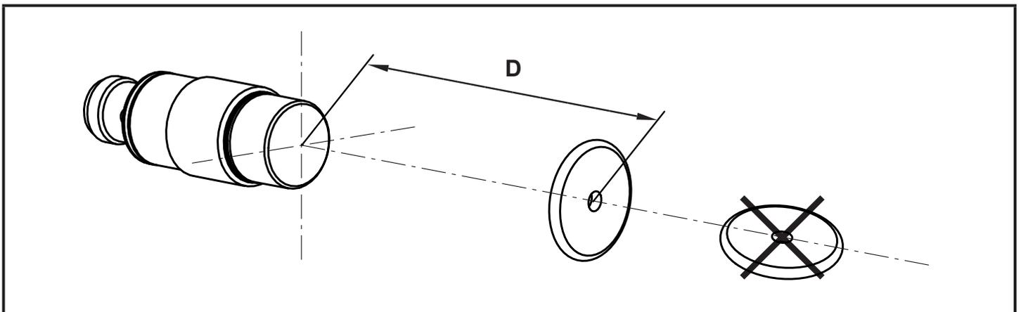
► ID-TAG zentrisch zur Antenne ausrichten
