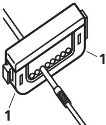
Schneiden Sie die Fiberoptik auf die passende Länge. Benutzen Sie jedes Loch des Cutters nur einmal!
