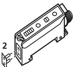
Adaptieren der Lichtleiter: s. Bedienungsanleitung zu Schaltverstärker OBF. Ist der Außendurchmesser der Lichtleiter < 2,3mm, muß zuerst der beiliegende Adapter (2) in den Schaltverstärker eingesetzt werden.
