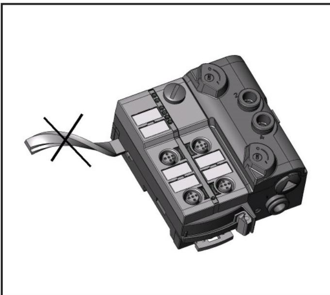
Poser le câble plat AS-i soigneusement, avec une longueur droite minimum d'environ 15 cm.
