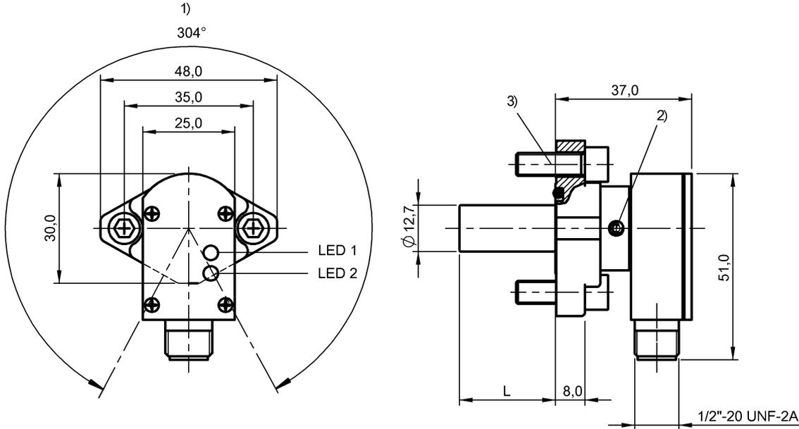
1) Корпус поворачивается на 304° 2) Момент затяжки 1...1,5 Нм 3) Момент затяжки 16,5 Нм
