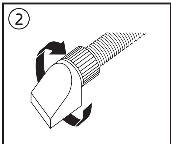
Drehen Sie den Winkelaufsatz bis er einrastet (ca. 10 Umdrehungen).
