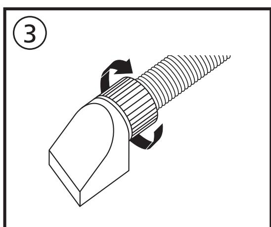
Ziehen Sie die Überwurfmutter (b) handfest an. (Verwenden Sie zur Montage keine Zange)
