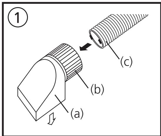
Stecken Sie den Winkelaufsatz (a) auf den Sensor (c).
