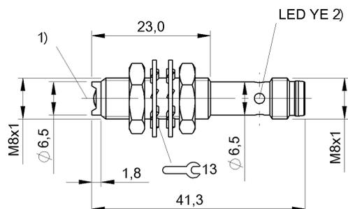
1) Оптическая ось, 2) Функция выхода
