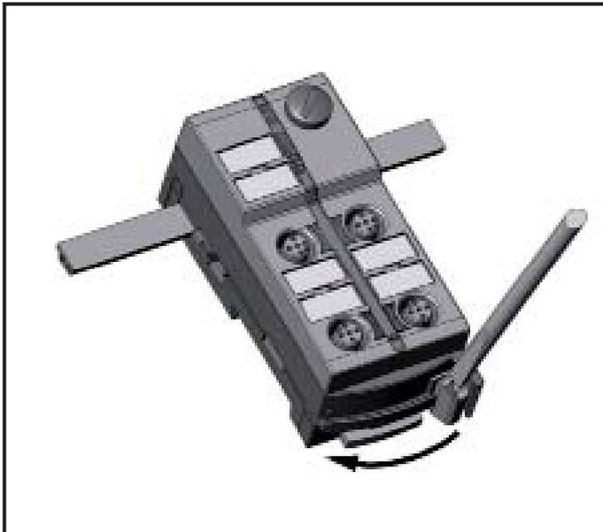
Öffnen Sie das Gerät wie abgebildet mit einem Werkzeug (z. B. Schraubendreher).
