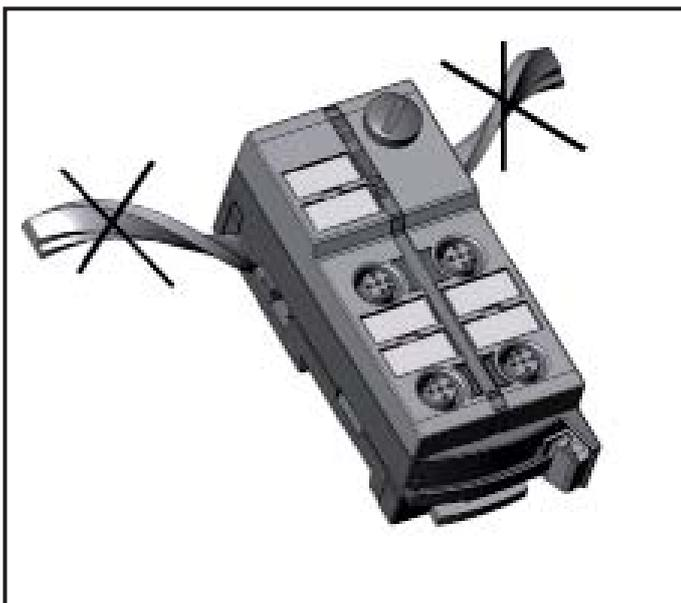
Verlegen Sie das AS-i Flachkabel sorgfältig, der gerade Verlauf des Flachkabels soll ca. 15 cm betragen.
