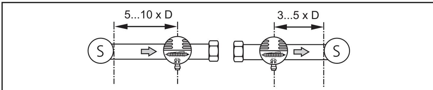
D = диаметр трубы; S = источник помех
