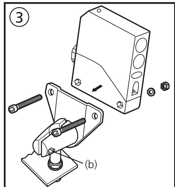
Ziehen Sie nach Montage und Ausrichtung des Sensors die Schraube (b) fest.
