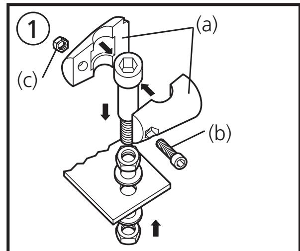
Montieren Sie die beiden Schellenhälften (a) lose mit Hilfe der beiliegenden Schraube (b) und Mutter (c).
