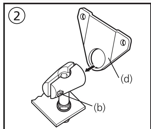
Befestigen Sie den Haltewinkel (d) und ziehen Sie anschließend die Schraube (b) soweit an, daß sich der Winkel noch drehen läßt.
