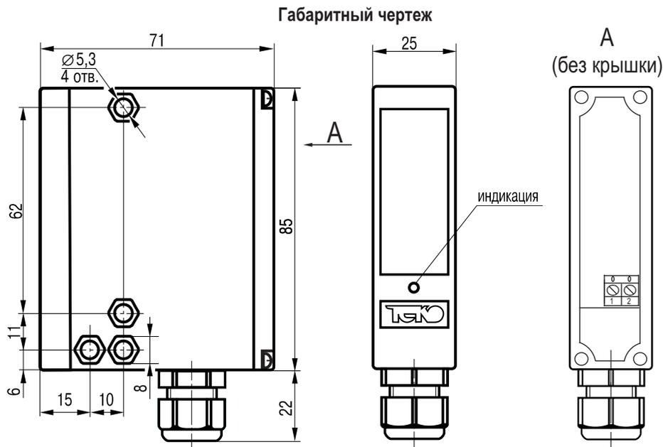
**Излучатель оптический бесконтактный
