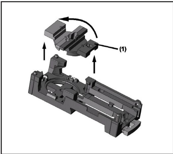
L'embase fournie permet l'orientation du câble plat dans trois directions.
