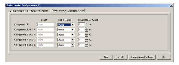
Il campo "Logica" indica la funzione base del pin. Nella colonna "Segnale" è possibile definire se si tratta di un segnale statico o di un impulso. Nel caso in cui si tratti di un impulso di segnale è possibile definire, nel campo d'immissione seguente, la lunghezza desiderata dell'impulso in un margine da 50 a 1000 ms.
