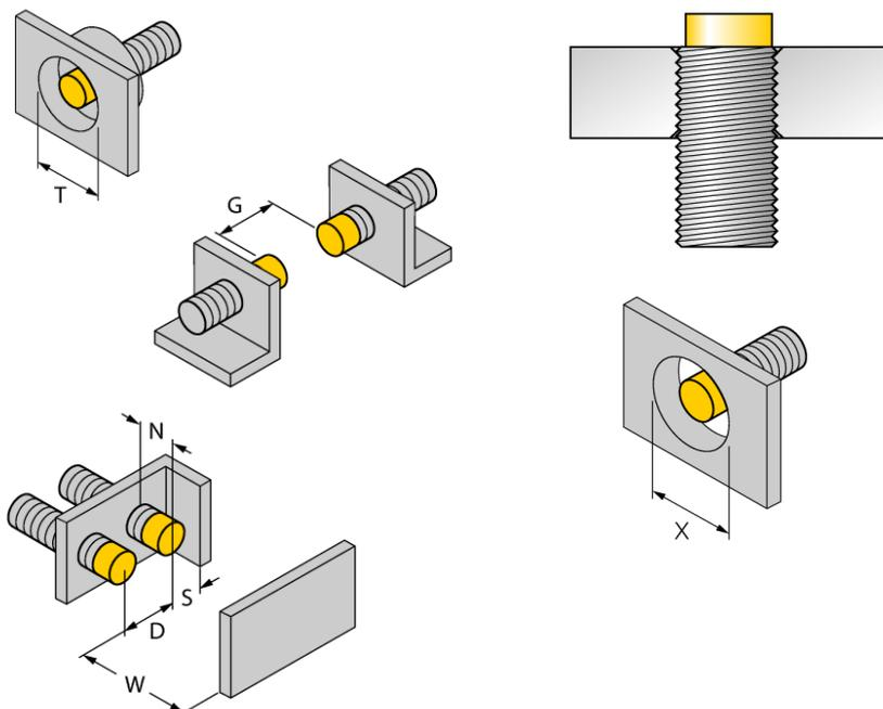
Все утапливаемые резьбовые цилиндрические датчики *iprox*®+ можно ввинчивать до верхней грани резьбы. Таким образом безопасная работа гарантируется при уменьшении макс. на 20% дистанции срабатывания.
