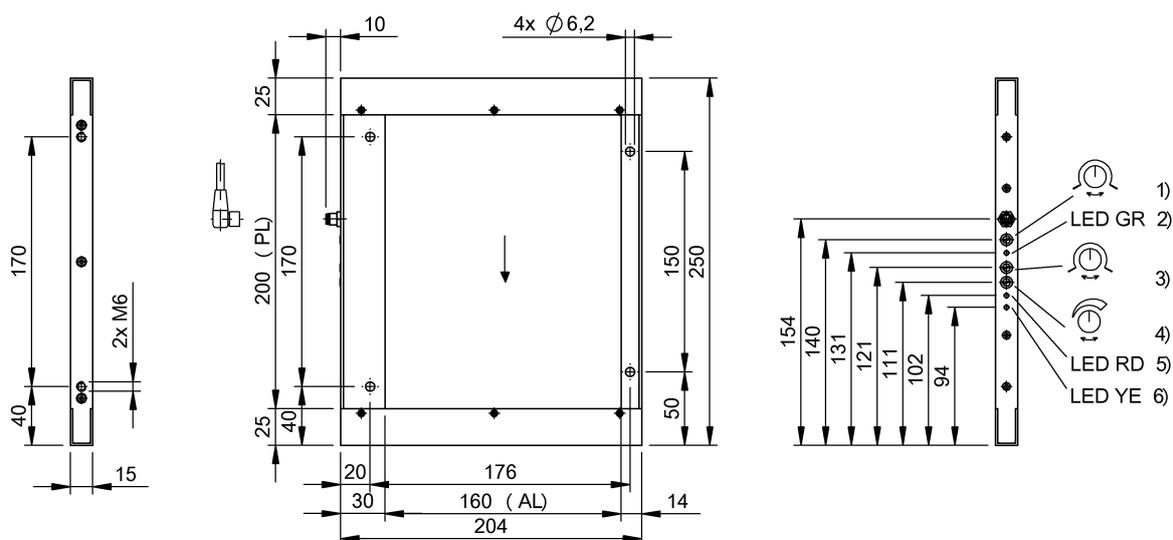
1) Продление импульса, 2) СД режима работы, 3) Коммутационная функция, 4) Разрешение объекта, 5) СД сигн. предупреждений, 6) Функциональный СД, 7) Оптическая ось
