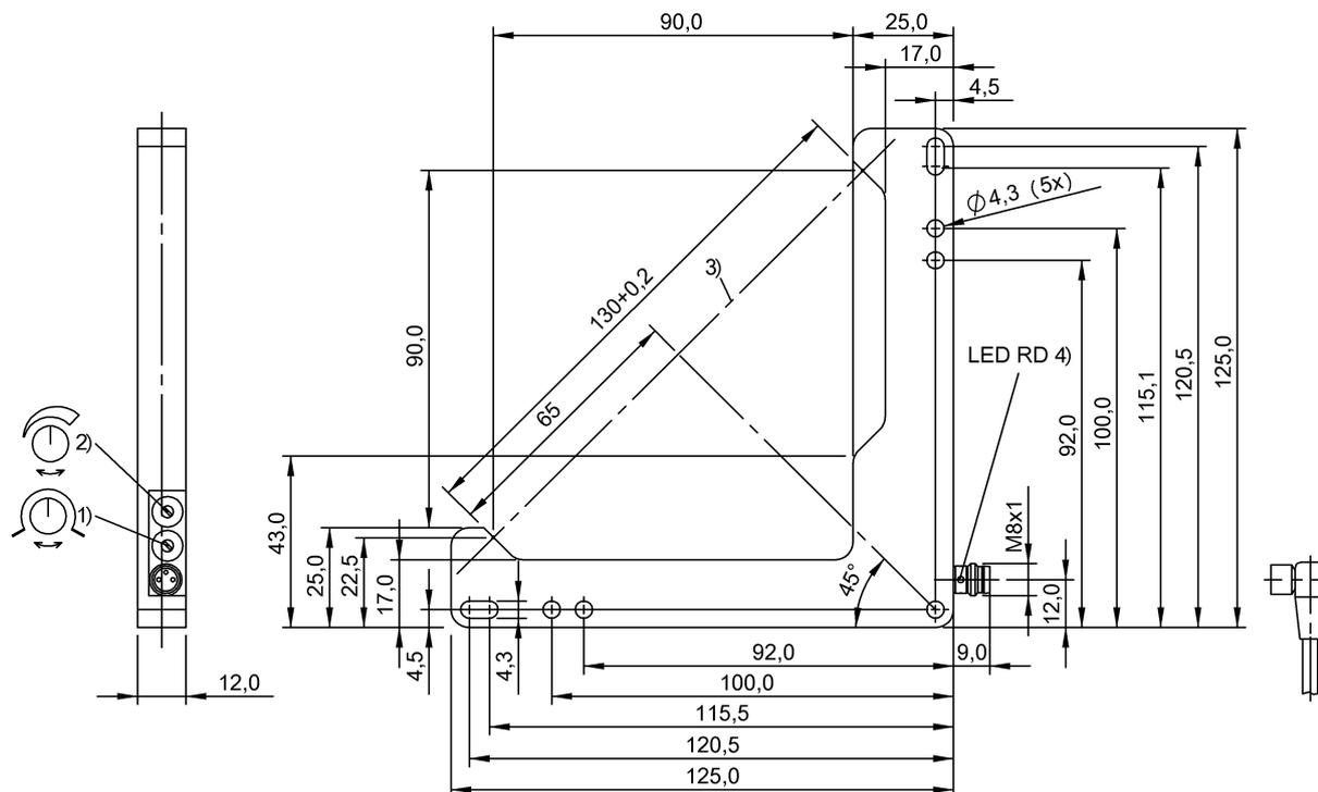
1) Включение при освещении / затемнении, 2) Чувствительность, 3) Оптическая ось, 4) Функция выхода
