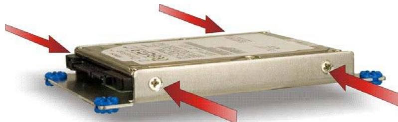
**Abbildung 4-5: HDD Halteschrauben**
