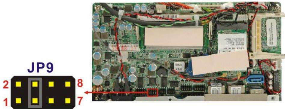
**Abbildung 4-9:** Lage „COM3 RX Funktionsauswahl“ Jumper
