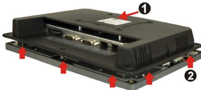
Abbildung 4-2: Entfernen der rückseitigen Abdeckung
