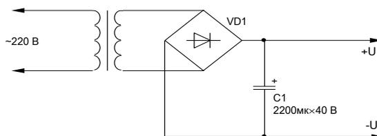
Рис. 7. Пример схемы источника питания выключателей
