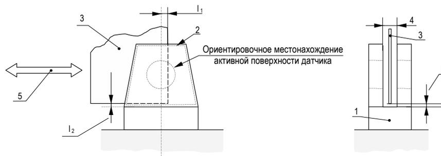
Рис. Б.2 - Методика определения работоспособности выключателей щелевого типа
