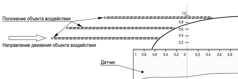
Рис. 5 - Зависимость срабатывания выключателей от положения объекта воздействия
