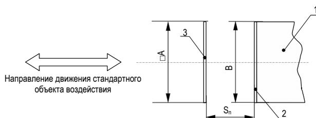
Рис. Б.1. Методика определения работоспособности выключателей не щелевого типа
