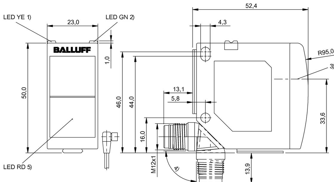
1) Функция выхода / сбой, 2) Напряжение питания, 3) Оптическая ось, 4) Поворачивается на 270°, 5) Хор. выравн. / пограничная область
