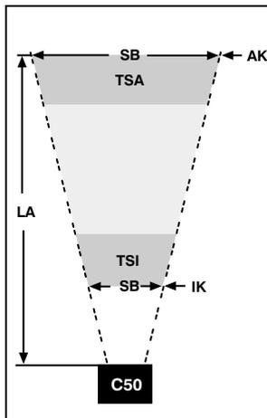
AK = Outer Edge    IK = Inner Edge    LA = Read Range    SB = Scan Width    TSA = Depth of Focus Outer Edge    TSI = Depth of Focus Inner Edge
