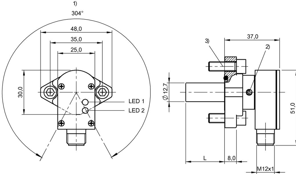
1) Корпус поворачивается на 304° 2) Момент затяжки 1...1,5 Нм 3) Момент затяжки 16,5 Нм
