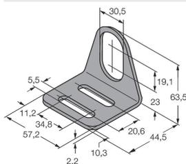
Кронштейн для резьбовых приборов; материал: Нерж. сталь A2 1.4301 (AISI 304)
