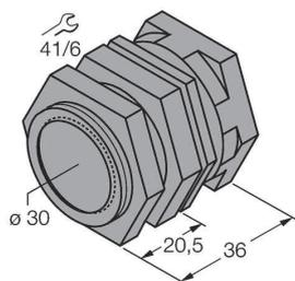
Зажим-фиксатор для быстрой установки; материал: хромированная латунь, внешняя резьба M36 x 1.5. Обратите внимание: Расстояние срабатывания датчиков приближения может сокращаться при использовании зажимов для быстрого монтажа.
