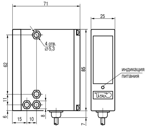
**Излучатель оптический бесконтактный
