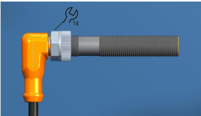
Para aplicações em ambientes agressivos, fixe a porca de acoplamento apertando mais uma ranhura com uma chave (tamanho 14) para aumentar a resistência a choques e vibrações.
