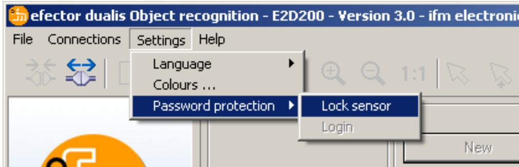
▶ 新しく開いたウィンドウの Password にパスワードを入力し、確認の為に Confirm password に再度パスワードを入力します。
