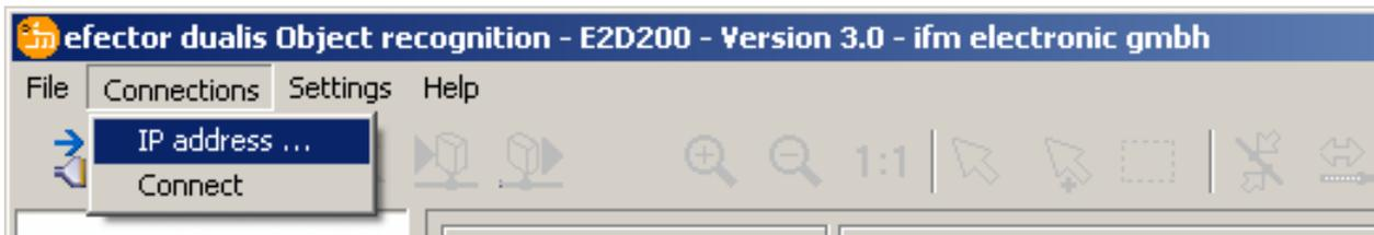
▶ "IP address" の入力欄にセンサーの IP アドレスを入力します。
