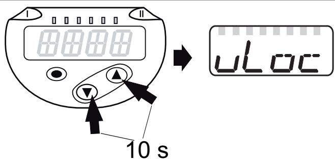
Заводская настройка прибора: в незаблокированном состоянии.
