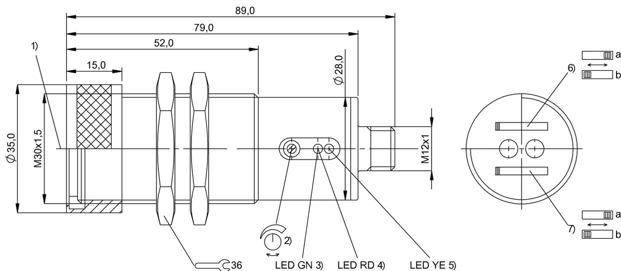
1) Оптическая ось, 2) Sn, 3) Напряжение питания, 4) Сбой, 5) Прием света, 6) a= 1x Sn / b= 0,5x Sn, 7) a = темно / b = светло
