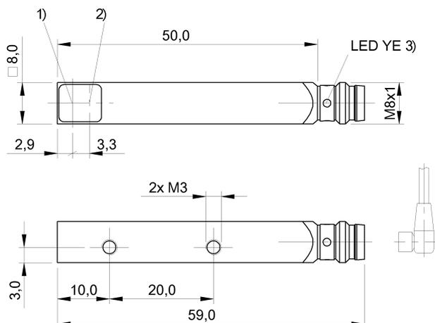
1) Оптическая ось, передатчик, 2) Оптическая ось, приемник, 3) Функция выхода
