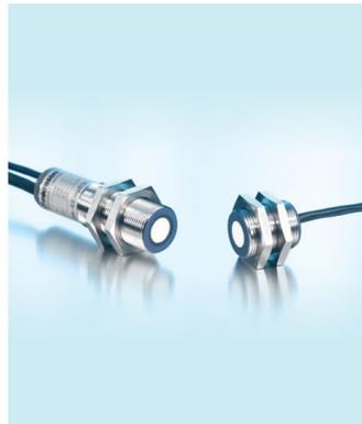
Стандартная модификация: приемник и вся измерительная часть находится в M18 резьбовой втулке, длиной всего 60,2 мм. Передатчик располагается в M18x21 мм резьбовой втулке и 2-контактным разъемом соединяется с приемником.
