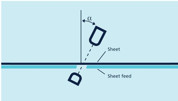
Обнаружение тонких гофрированных пластин оптимально при угле наклона  $\alpha \geq 35^\circ$ , тонкого листового металла или толстой пластиковой пленки при  $27^\circ$  и полупроводниковых пластин под углом  $11^\circ$
